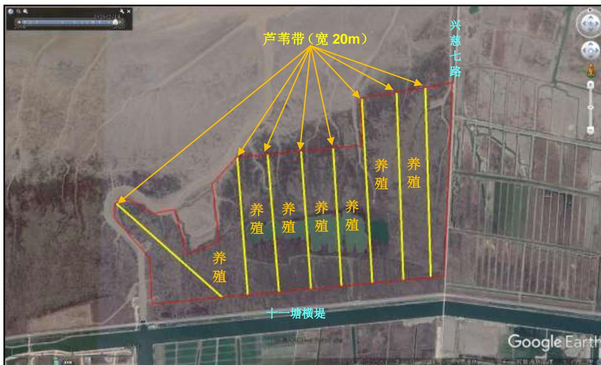
图 2.2-3 生态修复方案布置图
