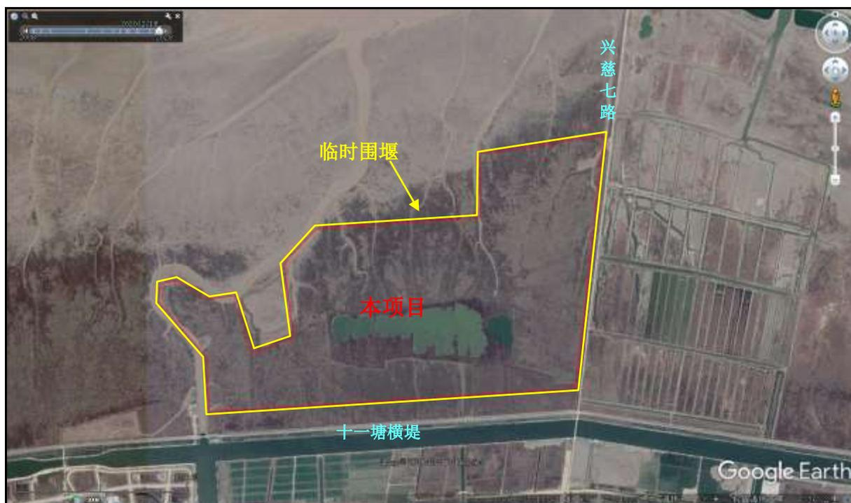
图 2.3-1 临时围堰平面布置图
